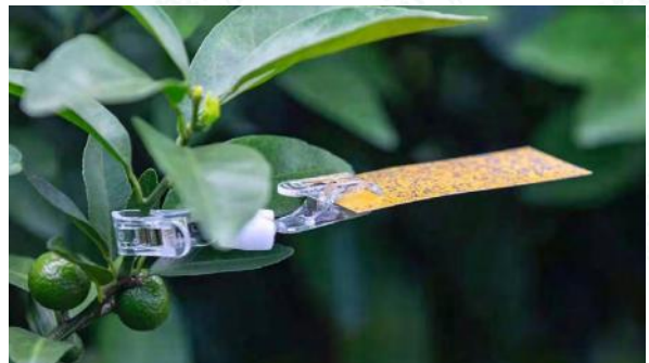
• 用水敏纸检测无人机果树喷洒质量和农药利用率
